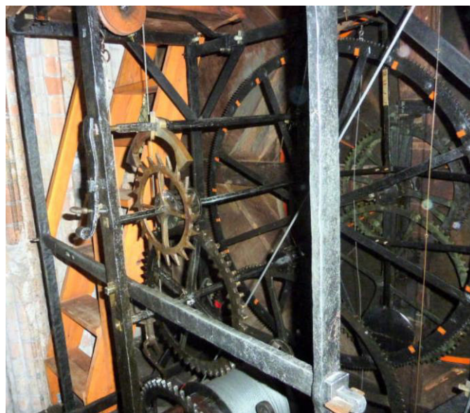
Bild 2-1: Das Räderwerk des Hauptwerkes von der Aufzugseite gesehen ([Koc15], S. 7)
