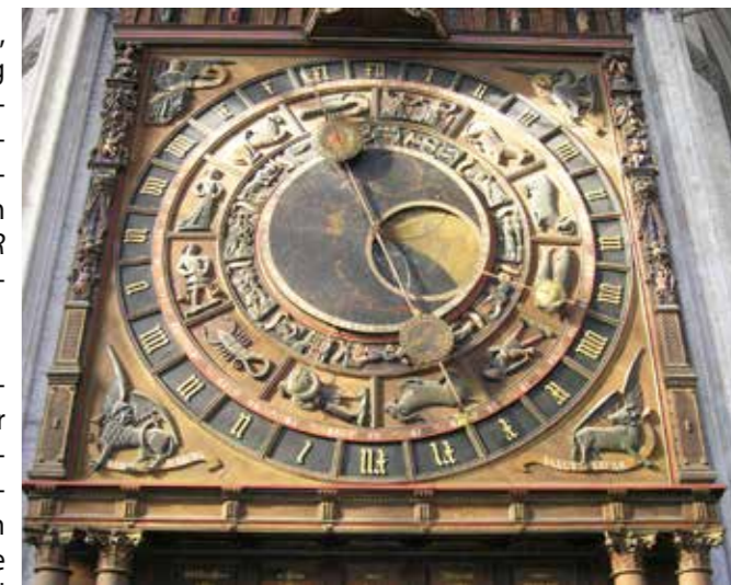
Die Uhrscheibe der Rostocker astronomischen Uhr von 1472. Auf dem Stundenzeiger ist die Scheibe der astrologischen Planetenstunden befestigt (Abb. unten).
