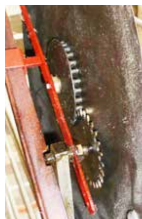
Ein Blick hinter die Planetenscheibe: Zu erkennen sind das 28-er Laternenrad und das 24-er Zahnrad, auf dessen Achse ein Massestück befestigt ist
